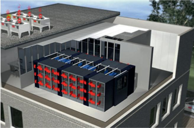
Кондиционеры CyberRow с передними воздуховыпускными отверстиями используются в изолированных холодных пролетах. Кондиционеры расположены в шахматном порядке, что обеспечивает оптимальную подачу воздуха ко всем серверным стойкам.
